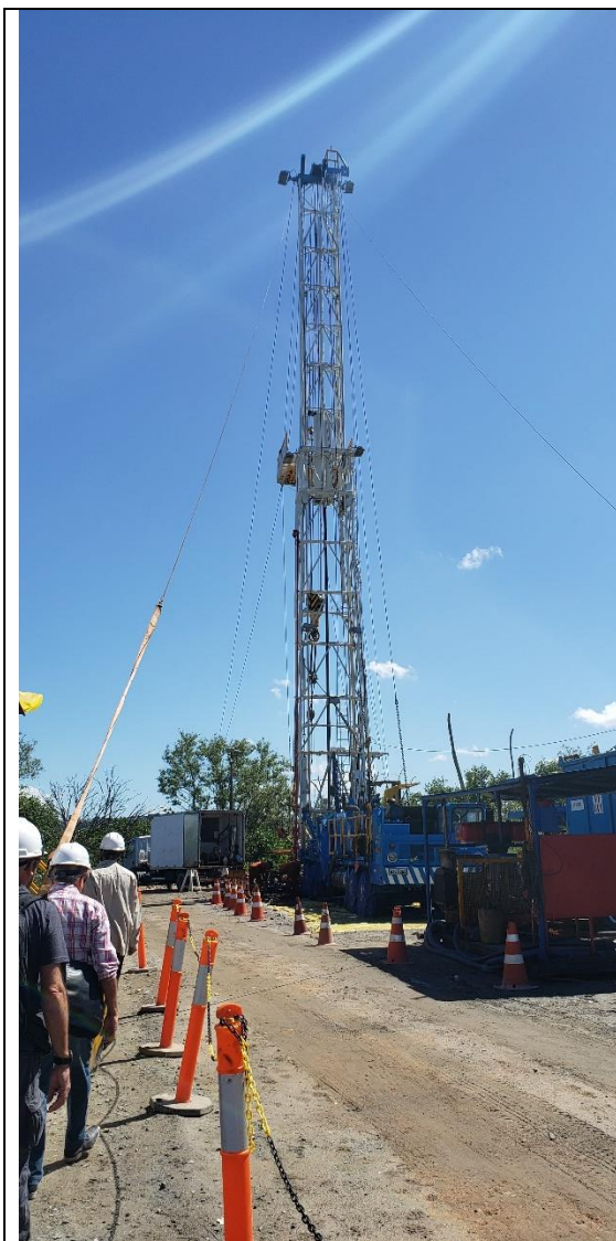
Poço 18 – Pescaria para realização de sonar
